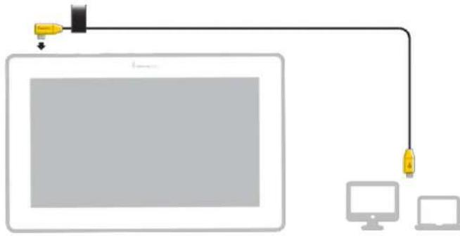
这条加粗设计的全功能 USB-C 数据线可同时传输视频信号、笔数据和供电，是专为数位屏设计的专用连接线。为确保正常使用，请仅使用此数据线。当光标能准确跟随笔尖移动时，即表示数位屏工作正常。
